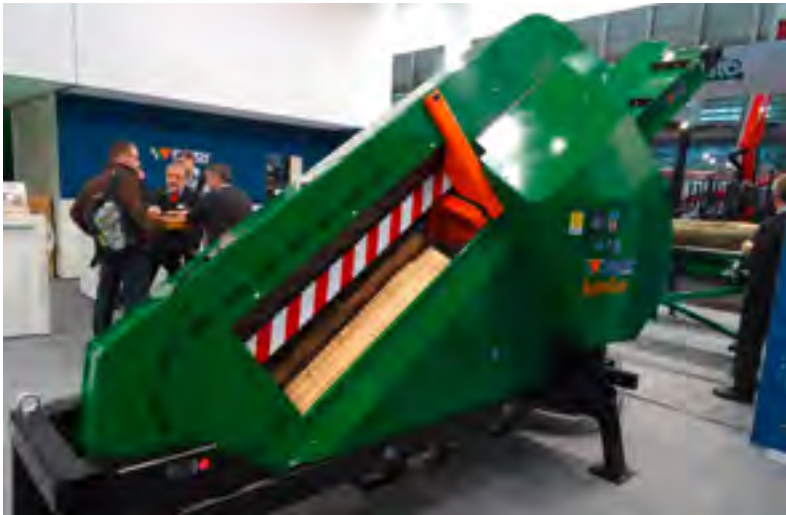
Die Säge AutoCut von Posch hat eine digitale Schnittlängenkontrolle und eignet sich für vier bis fünf Scheite. Sie kostet rund 21 000 €.
