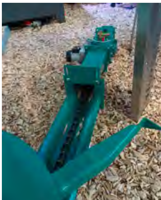
Per Kette (statt per Schnecke) fördert Heizomat Hackschnitzel aus dem Lager zum Kessel. Vorteile sollen ein störungsfreier Betrieb, geringerer Verschleiß und 50 % Energieeinsparung sein.
