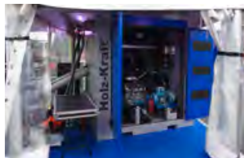
Der Holzvergaser der Firma Spanner hat eine Leistung von 9 kW el und 25 kW th .
