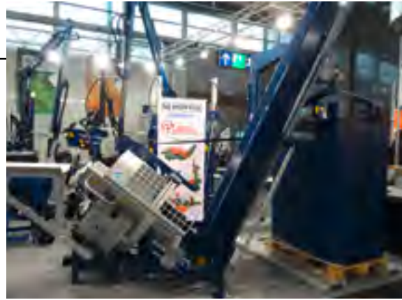
Die Wippsäge der Firma Scheifele hat eine schräge Zuführung. Mit Hilfe des rechteckigen Trommelwicklers lassen sich Europaletten optimal nutzen.
