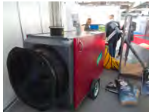
Einen mobilen Warmluft-erzeuger, der mit Holzpellets befeuert wird und in drei Größen von 120 bis 230 kW angeboten wird, zeigte Energynova.
